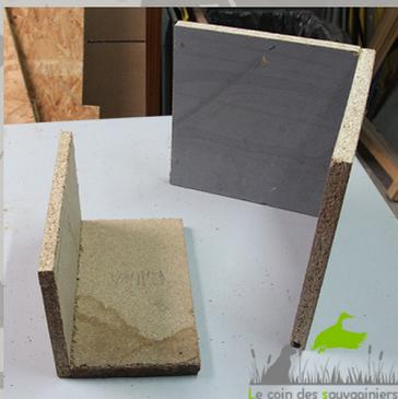
Lors des deux prochaines étapes, vous mettrez en place le fond du nichoir à chicane sur la face avant et le côté droit et assemblerez le pallier / côté gauche à la planche qui fera office de cloison. Comme vous pouvez le constater sur la photo ci-dessous, l'ensemble du pallier/côté gauche est plus long que la cloison. Il s'agit de laisser l'espace pour assembler ce bloc à la face avant.
